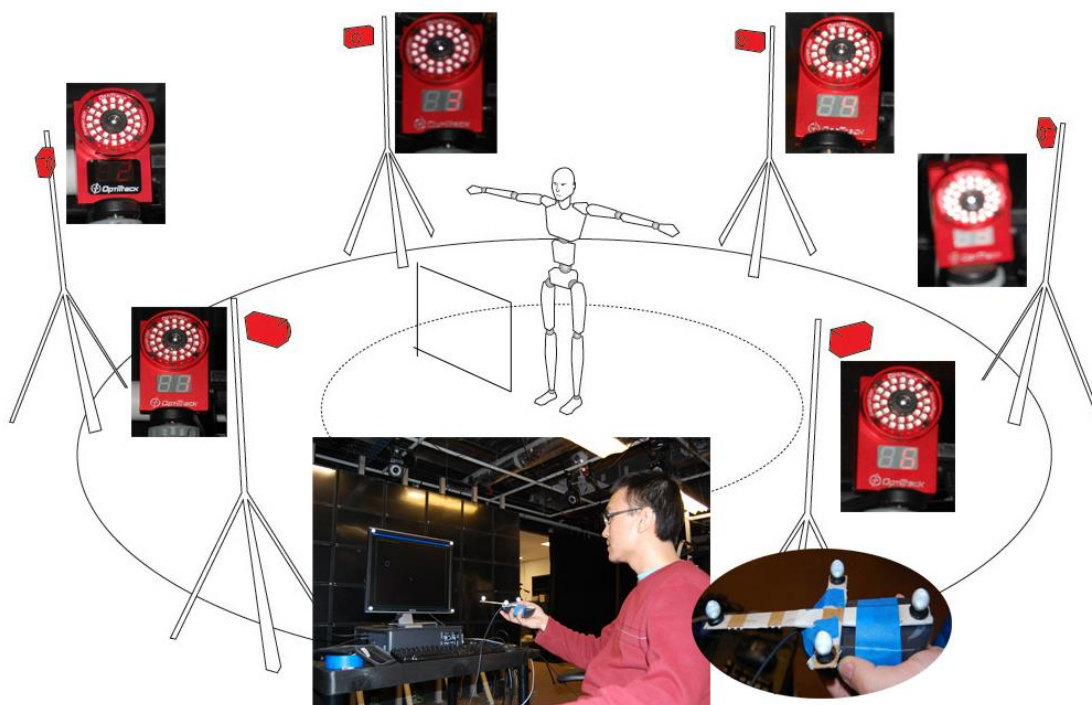
Слика 6.2. Хардверске компоненте 3D OptiTrack система ( http://people.cs.vt.edu/fangb/project7.html )
